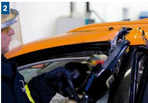
Abtrennen der B- und C-Säule
