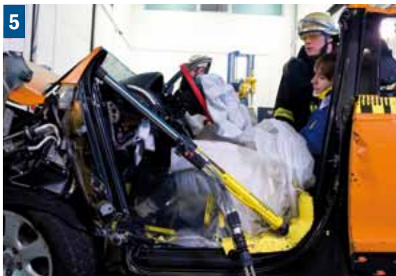
Erweitern des Fußraums durch Rettungszyylinder
